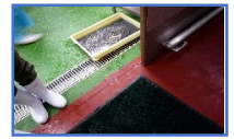
人が作業室から通路に出る手順 洗浄槽で洗う→水切り→マット
